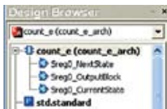
Рис. 4. а) VHDL-модель ЦА, реализующего двоичный счетчик с входом разрешения E (стиль кодирования — Three Processes); б) имена процессов в окне просмотра проекта Design Browser
