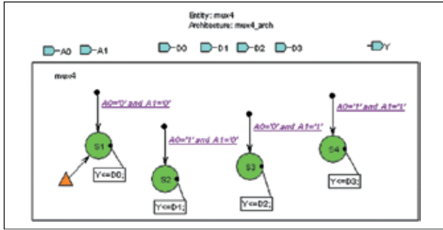
Рис. 15. Глобальные переходы позволяют создавать очень компактные автоматные описания комбинационных схем
